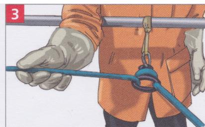
3 Accrocher le descendeur en huit au mousqueton. Tester le fonctionnement du freinage de la corde
