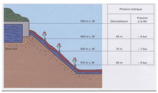
La pression statique (sans transformation) à la sortie de la borne hydrante est donnée par la différence de hauteur entre le réservoir d'eau d'extinction et la borne hydrante (10m de dénivellation = env. 1 bar)
